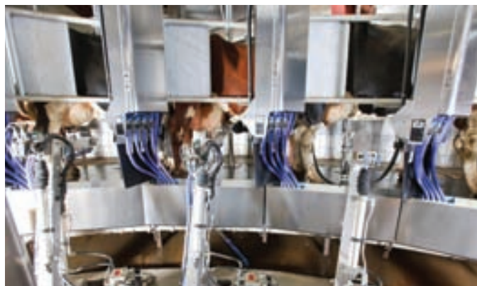
2. ábra. A karusszelben lévő specializált manipuláló karok
