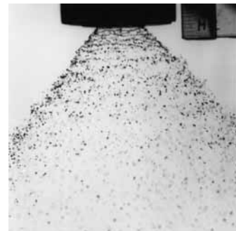
2. kép: Üreges-kúpos fúvóka cseppképzése, 1% Melius alkalmazásával, 1,5 bar nyomáson
