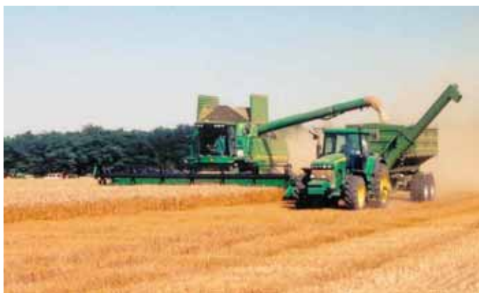
3. ábra. Az automata kormányzás GPS-vezérléssel: ~100%-os munkaszélesség kihasználás érhető el
