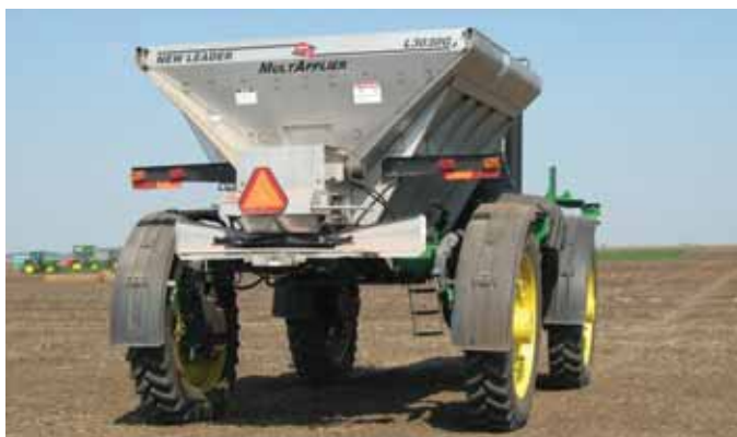
2. ábra. Differenciált tápanyag-visszapótlásra alkalmas, osztott tartályos műtrágyaszóró magajáró alvázon
