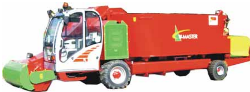
1. ábra. Három függőleges csigás, ellenőrző kamerával felszerelt, maródobos, önrakódós keverő-kiosztó kocsival
